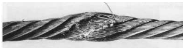
Bild 7. Drahtseil mit Abplattung, entstanden durch Überfahren
