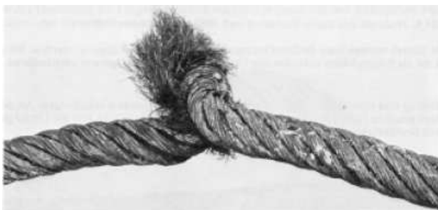
Bild 8. Drahtseil mit Klanke
