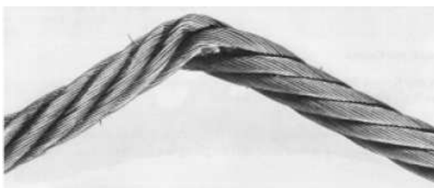
Bild 9. Drahtseil mit Knick
